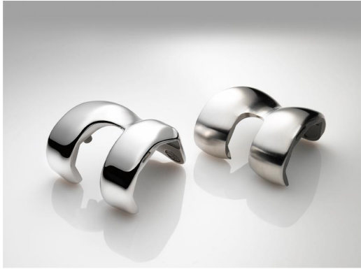
Foto 2: Protesi per ginocchio prima e dopo la finitura OTEC (Foto: OTEC)
