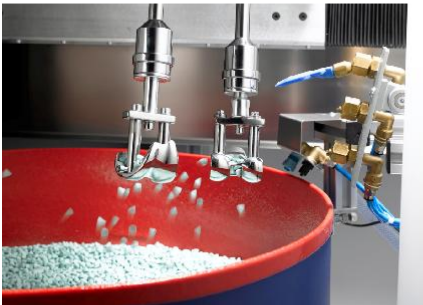
Foto10: dispositivo di scarico ad aria
